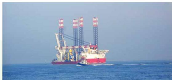
Errichterschiff für Offshore-Windenergie vor Cuxhaven
